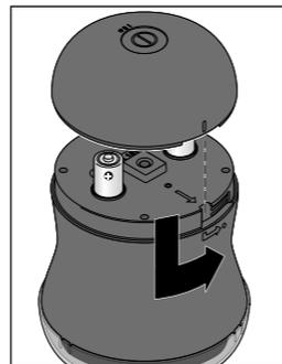
4. Setzen Sie den Batteriefachdeckel wieder auf. Die Rastnase im Deckel muss dabei in die mit dem Pfeil markierte Aussparung am Gerät greifen. Drehen Sie den Deckel dann gegen den Uhrzeigersinn fest.
