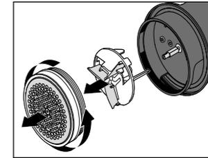
3. Drehen Sie den Scherkopf gegen den Uhrzeigersinn ab.
